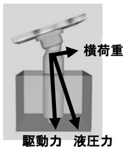
図 1 一般のピストンに働く横荷重
